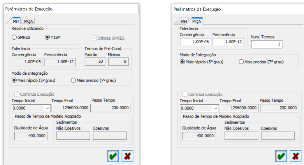
Figura 6. Imagem das janelas de Parâmetros de Execução de modelos hidrodinâmicos (MH) à esquerda e de modelos de transporte (MQA) à direita, com opções e valores presumidos. Note que na janela do MH, o quadro inferior inclui informes sobre possíveis modelos de transporte acoplados 34 .
